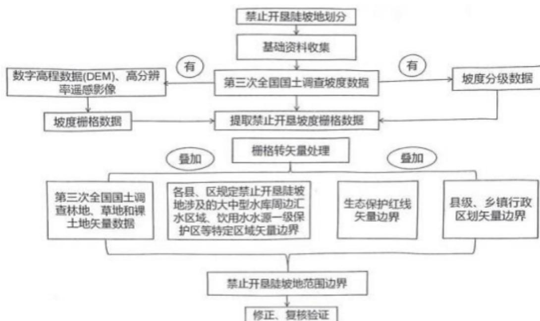
图 2-1 禁止开垦陡坡地范围划定技术路线图
